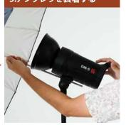
ストロボを片手で抑え、アンブレラの 芯を「リフレクターとストロボ本体」の アンブレラホールに挿入する。アンブレラ固定ネジでアンブレラの芯を ロックして、アンブレラが前後にずれないかを確認する。
